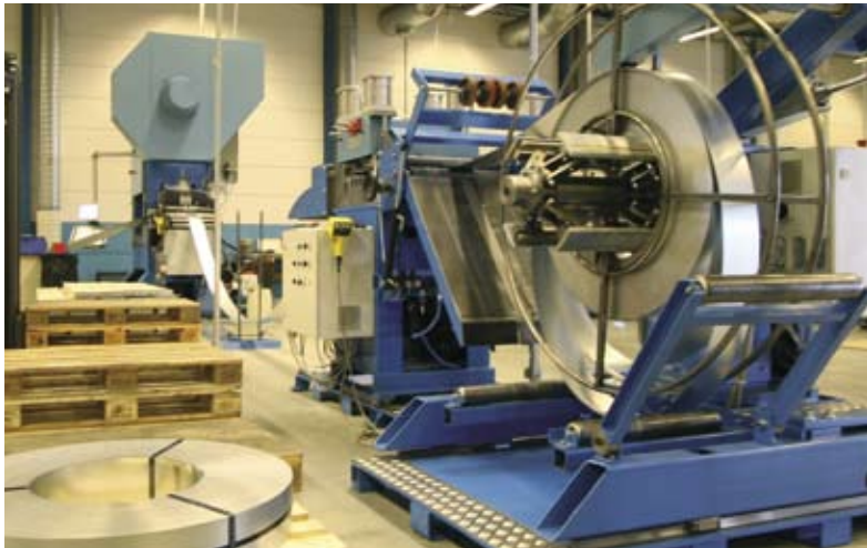
Linjen från SMV med excenterpressen FCP1600-2 (160 ton), valsmataren RF500, riktverket S503 (bandbredd 500 mm) och haspeln H2000 (bandvikt max 2000 kg) är det senaste tillskottet i raden av maskiner från SMV Industrier som står på Turols golv.
